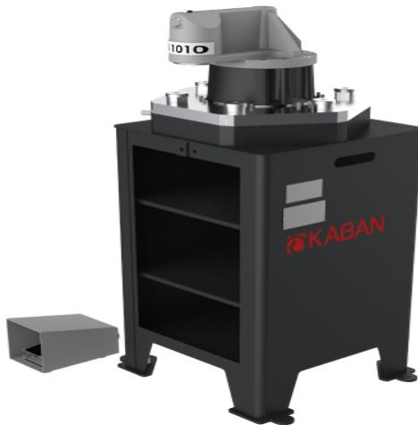
Прочная механическая конструкция - Приложение давления 4700 кг с помощью гидропневматической системы управления. - Возможность использования 6 комплектов цулаг без демонтажа
